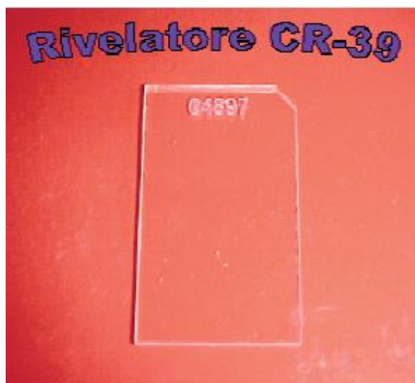
Figura 2 - Rivelatore SSNTD di CR-39
