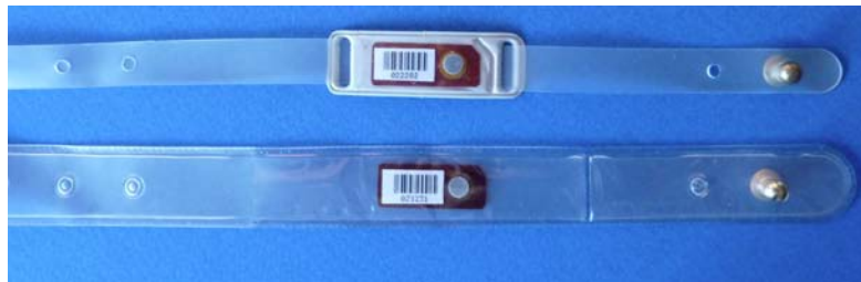
Dosimetro per estremità con rivelatore sottile di MCP-Ns con supporto a bracciale e bracciale sterilizzabile
