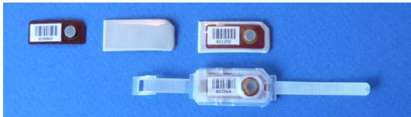
Dosimetro per estremità con rivelatore di MCP-Ns con supporto ad anello
