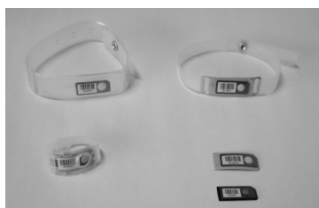
Figura 1: Dosimetro a termoluminescenza per fotoni. Figura 2: Dosimetro a termoluminescenza per neutroni termici.
